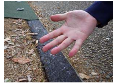
プライマーが手に付かない
